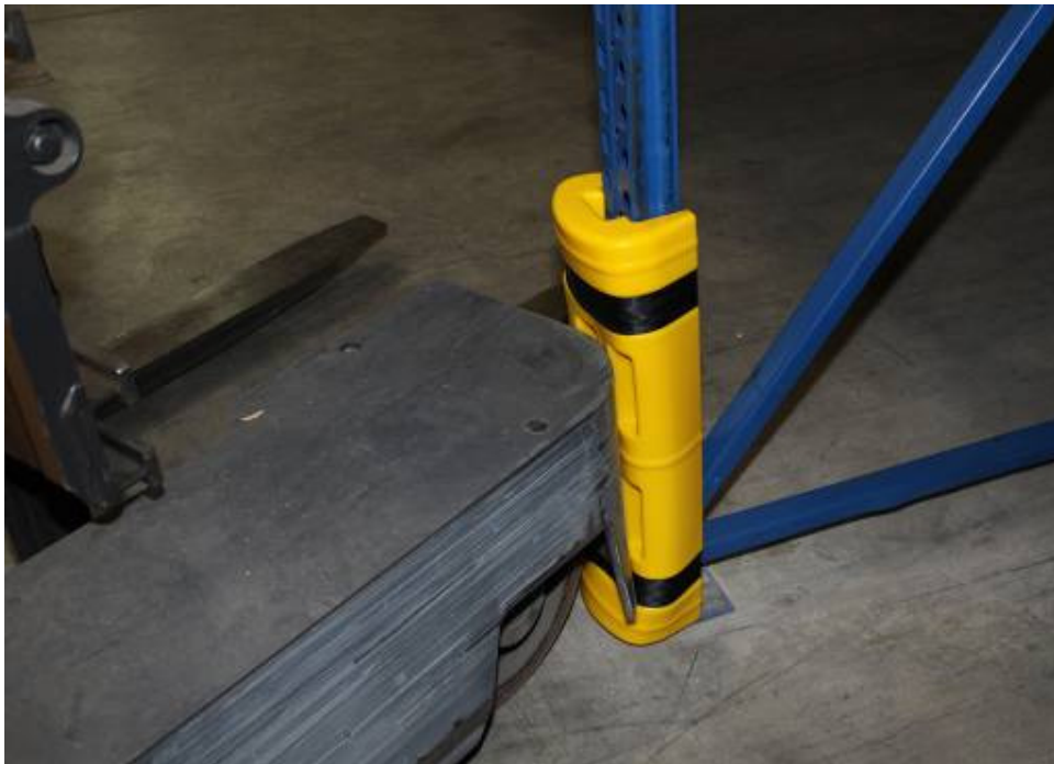
Rys.10. Przykład zastosowania odboju regałowego. Źródło: www.fraunhofer.de
