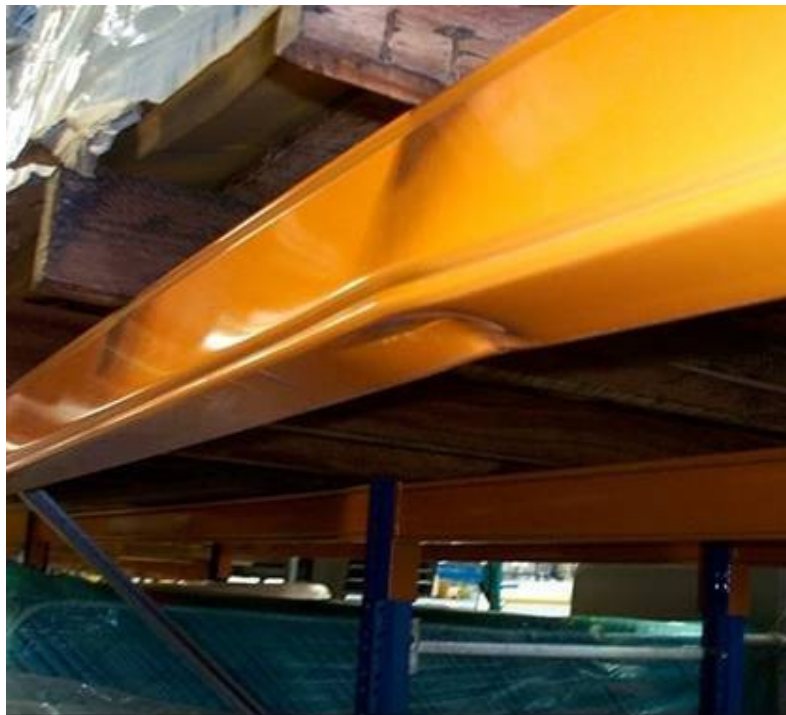
Rys.8. Przykład uszkodzenia trawersy regału magazynowego. Źródło: www.inspectarack.com
