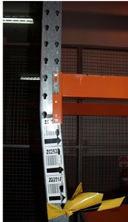
Rys.4. Wizualizacja kierunku pomiaru w płaszczyźnie równoległej do korytarza wraz z przykładem tego typu uszkodzenia regału magazynowego. Źródło: www.inspectarack.com
