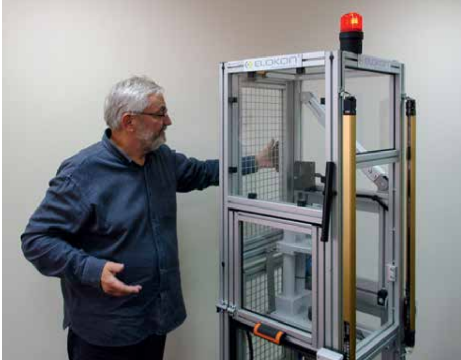
Stanisław Kowalewski na stanowisku badawczym (symulator prasy pneumatycznej) objaśnia prawidłowe i nieprawidłowe działanie typowych środków ochronnych: osłon stałych i ruchomych, kurtyny świetlnej, urządzenia sterowania oburęcznego, urządzenia zezwolenia.
